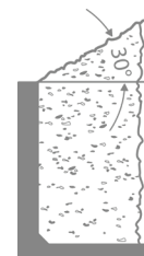
Lastfall 3 Böschung Gelände- neigung 30°
