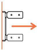
**!** Beim Eindrehen werden die Pfettenkonsolen nach innen geschoben, nach dem Positionieren können sie wieder nach außen geschoben werden und fixieren so die Rinne am Rahmen.
