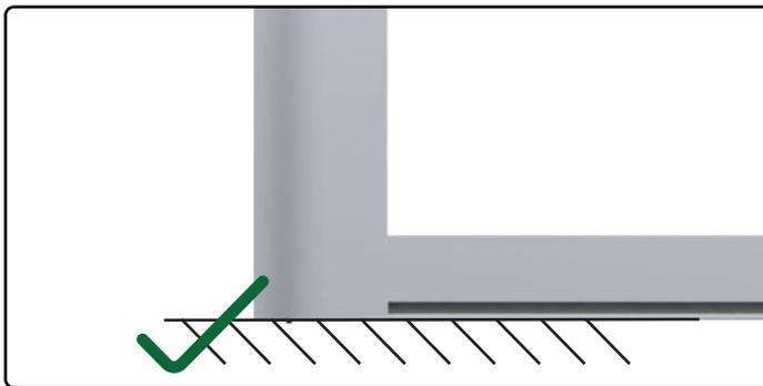
**!** Achten Sie auf ein gleiches Niveau von Eckprofil und Bodenprofil.
