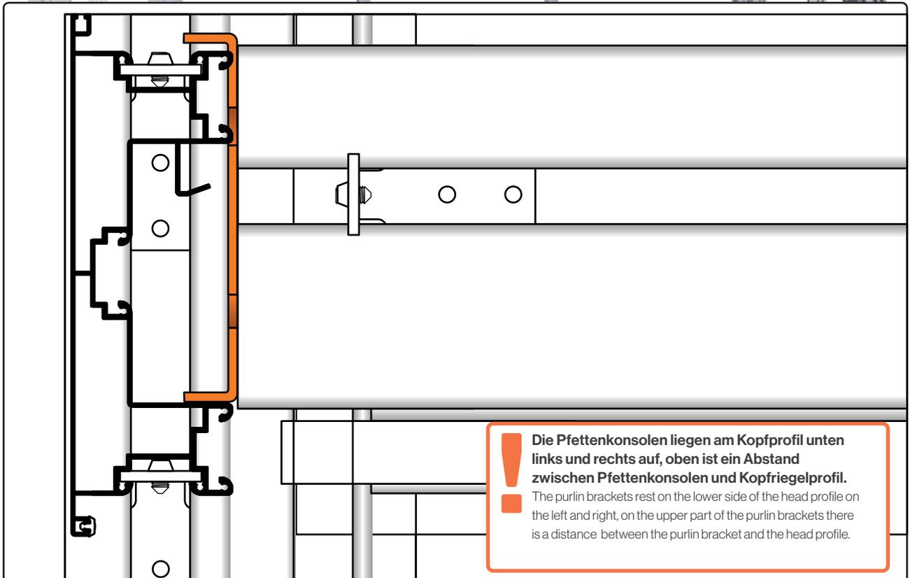
**!** Die Pfettenkonsolen liegen am Kopfprofil unten links und rechts auf, oben ist ein Abstand zwischen Pfettenkonsolen und Kopfriegelprofil.
