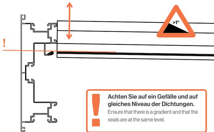
**!** Achten Sie auf ein Gefälle und auf gleiches Niveau der Dichtungen.
