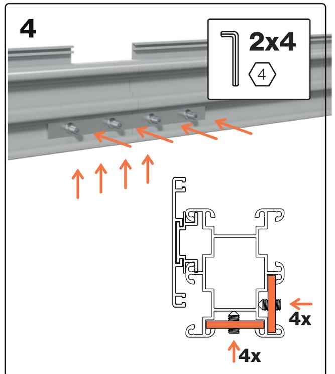
**!** Stellen Sie sicher, dass jede Verbindung ohne Spalt verschraubt wird.
