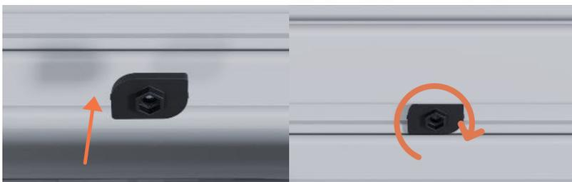
Mutter M8 (DIN934) in den Kunststoff - Nutstein eindrücken. Der Nutstein kann in die gewünschte Profilnut eingesetzt und durch eine 90° Rechtsdrehung im Profil positioniert und gesichert werden.
