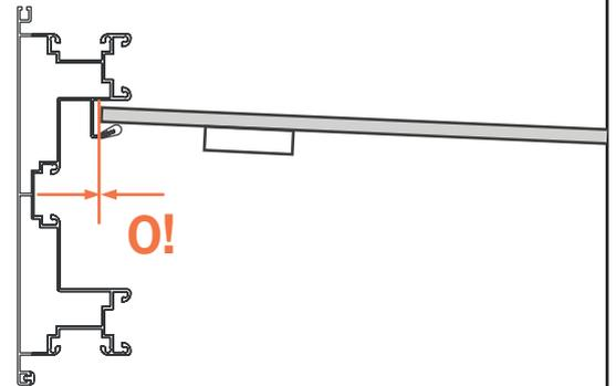
**!** Bei der Montage sind die Dachfüllungen immer ganz nach vorne gegen das Kopfprofil zu drücken.
