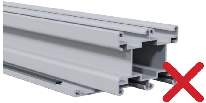
Es ist zu beachten, dass sich die verwendeten Dichtungen nach dem Einbau im Profilkanal zusammenziehen. Wir empfehlen, die Dichtungen beidseitig mit einer Überlänge von mindestens 25 mm zu montieren und nachdem sich die Dichtungen gesetzt haben bündig mit dem Profilkanal abzuschneiden. Bei Dichtungen mit Sonderlängen weisen wir in der Montageanleitung darauf hin. Bei den Dichtungen sind Stückelungen zulässig.
