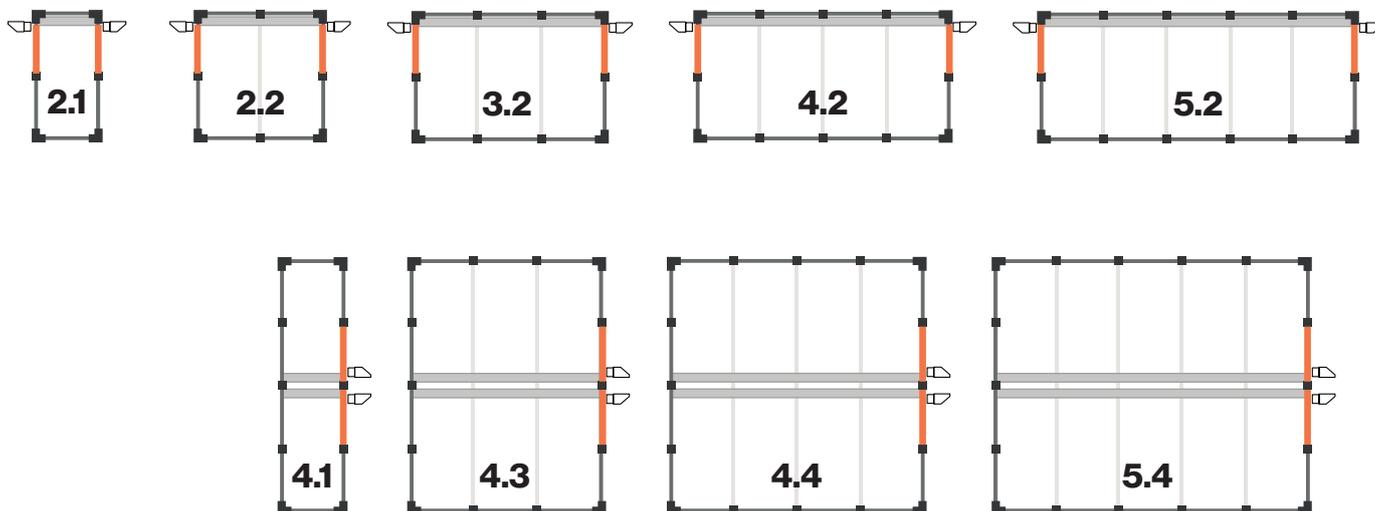
**An den Positionen mit Regenwasserauslass (Speier bzw. Regenfallrohr) wird statt des Kopfprofils A8 das „Kopfprofil Speier“ A9 montiert.**
