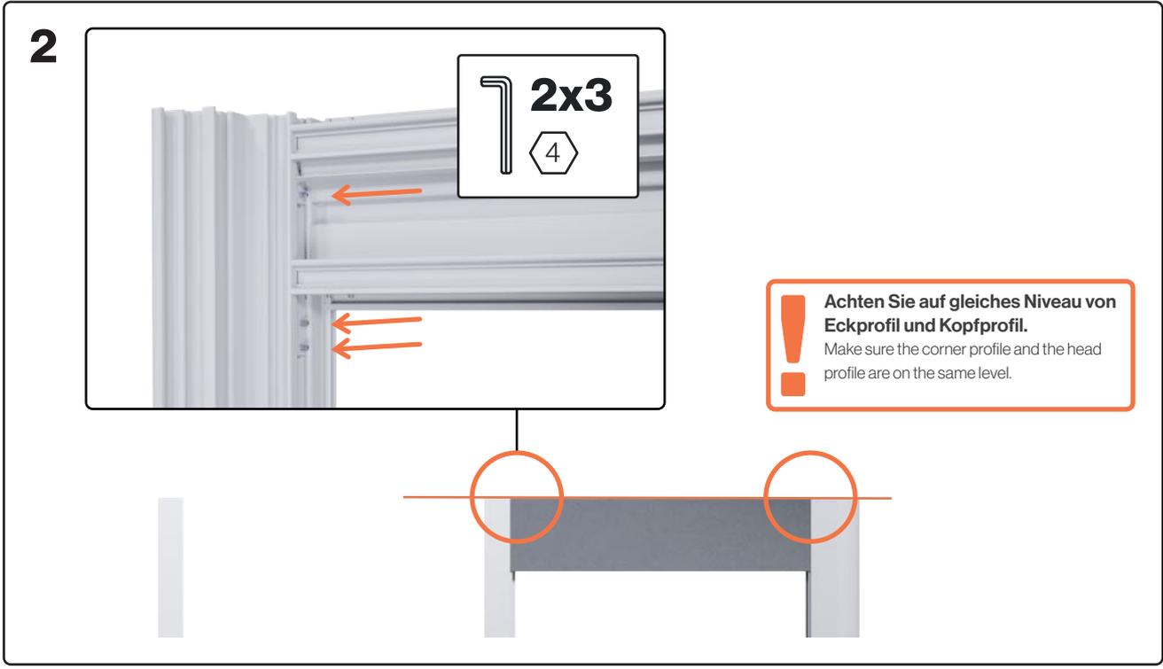
**Achten Sie auf gleiches Niveau von Eckprofil und Kopfprofil.**
