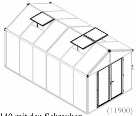
Befestigen Sie die in Schritt 6 montierten Türen am Türrahmen 7139 und 7140 mit den Schrauben 7088 (8.1). Schieben Sie die Fenster von der Front-/Rückseite in das Firstprofil (8.2). Montieren Sie den Dachfensterfeststeller 7369 mit den selbstschneidenden Schrauben 7349 auf beiden Seiten des Dachfensters (8.3)(8.4).
