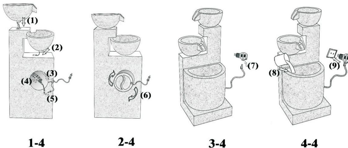
1. Befestigen Sie die obere Schüssel (D) am Brunnenkörper (G). Der flexible Schlauch und das Kabel der LED-Beleuchtung muss durch das Loch im Brunnenkörper (G) verlaufen.
