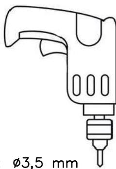
Bohrer:  $\varnothing 3,5$  mm
