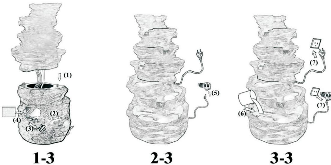
1. Befestigen Sie den oberen Brunnenkörper (G) auf dem unteren Brunnenkörper (H). Stellen Sie sicher, dass der flexible Schlauch und das Kabel der LED-Beleuchtung durch den Brunnenkörper verläuft.
