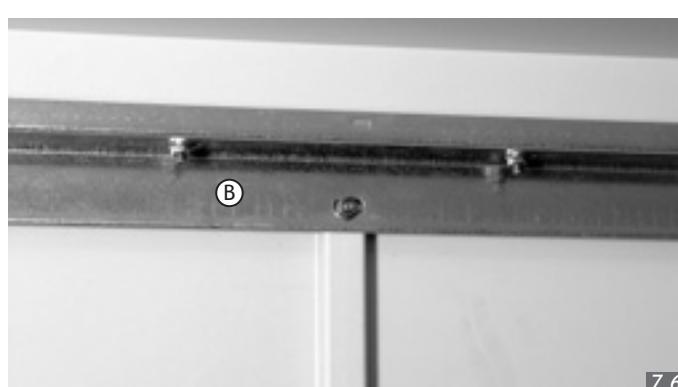
**8.** Bringen Sie nun am linken Türflügel (=ohne Loch für Drehgriffzylinderschloss) oben und unten die Scharnieroberenteile (Prägung L beachten) samt den Versteifungsplättchen an. Hängen Sie nun den linken Türflügel vorsichtig ein. Pressen Sie oben und unten die Kunststoff-Führungen für die Verriegelungsstife wie dargestellt ein. Führen Sie die Verriegelungsstife ein und bringen Sie die weißen Gummipuffer am Türflügel oben und unten (siehe Pfeile) an.
