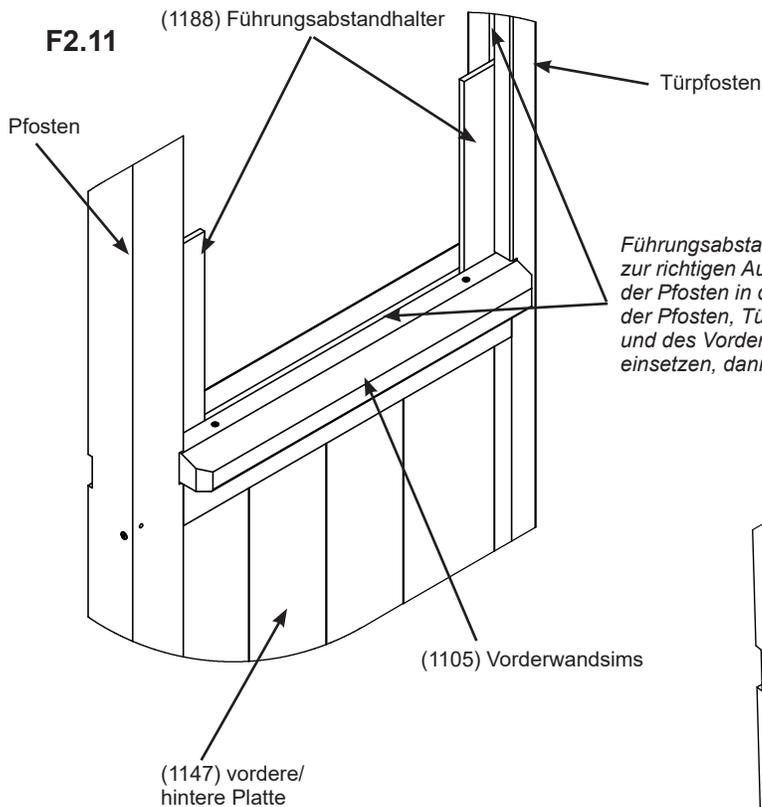
*Führungsabstandhalter zur richtigen Ausrichtung der Pfosten in die Rillen der Pfosten, Türpfosten und des Vorderwandsims einsetzen, dann entfernen.*
