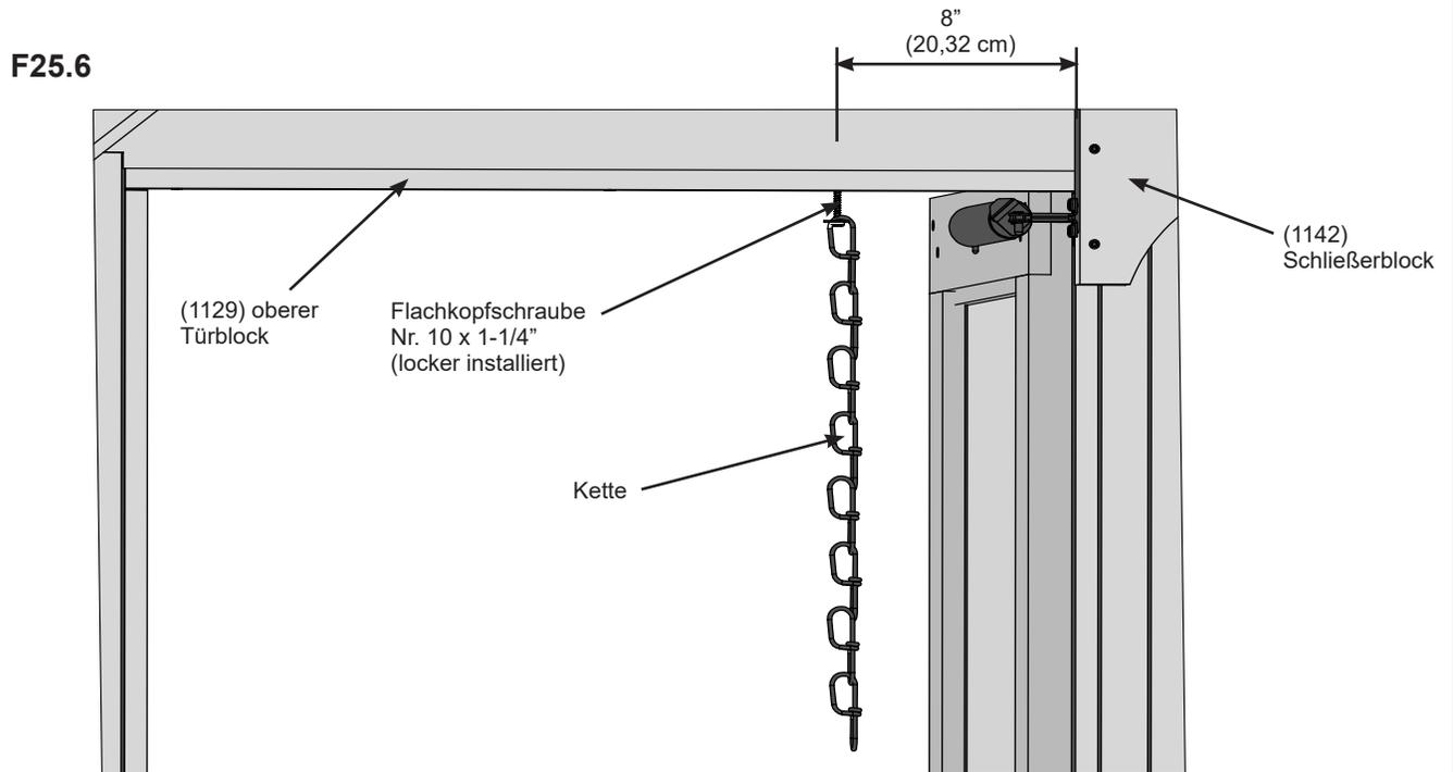
**F:** Messen Sie 5" (12,7 cm) vom Ende der (1175) Türplatte, bringen Sie dann die Kettenhalterung mit zwei Flachkopfschrauben Nr. 10 x 1-1/4" an. (F25.6 und F25.7)
