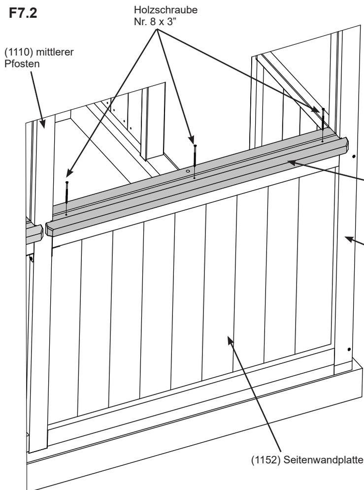
*Führungsabstandhalter zur richtigen Ausrichtung des Seitenwandsims in die Rillen der Pfosten und des Seitenwandsims einsetzen, dann entfernen.*
